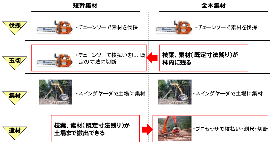
参考資料図2-1 短幹集材と全木集材の工程
