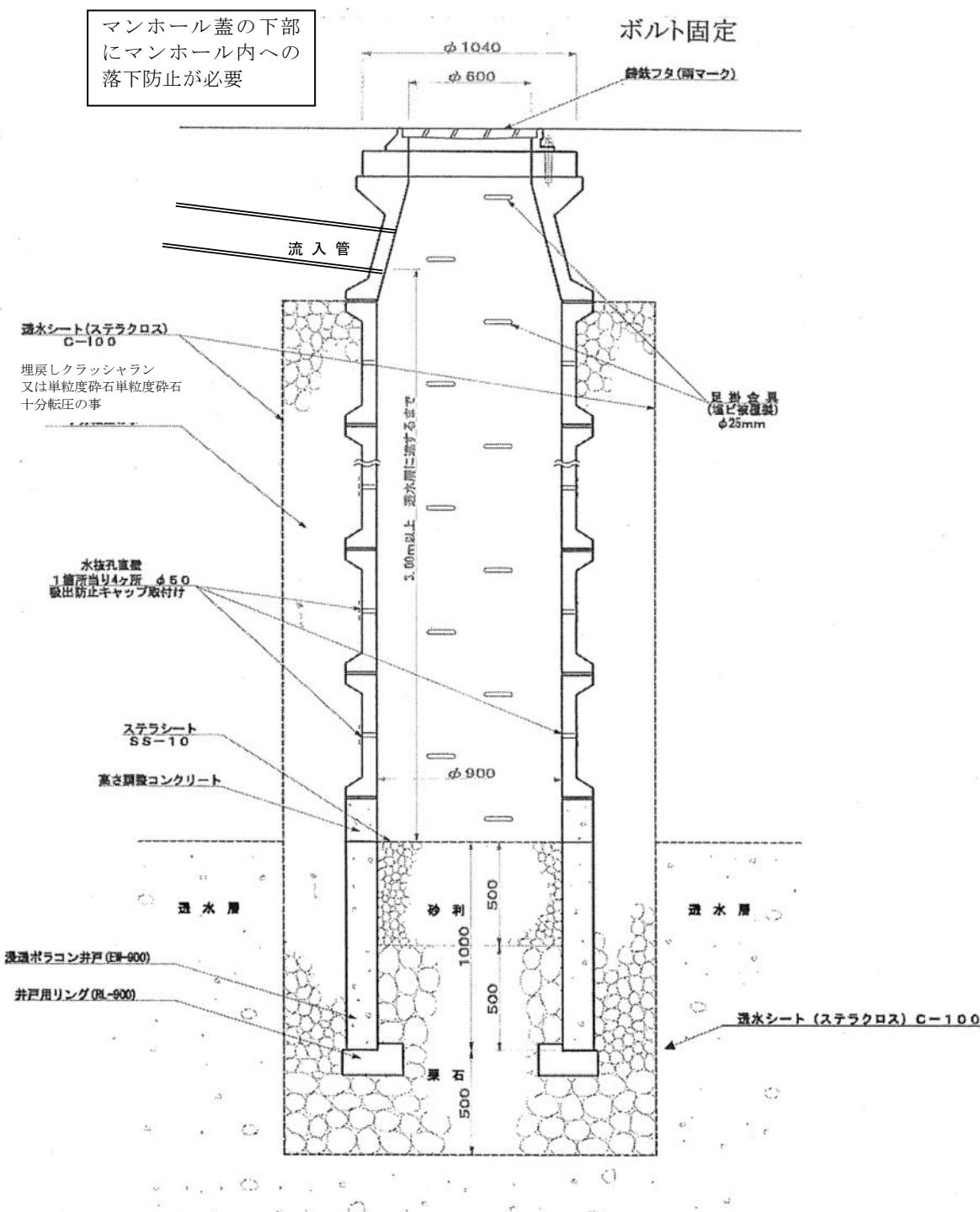
図4-6-2 地下浸透柵標準図（流末がなく1宅地（処理区域）の面積が500m<sup>2</sup>未満の場合）
