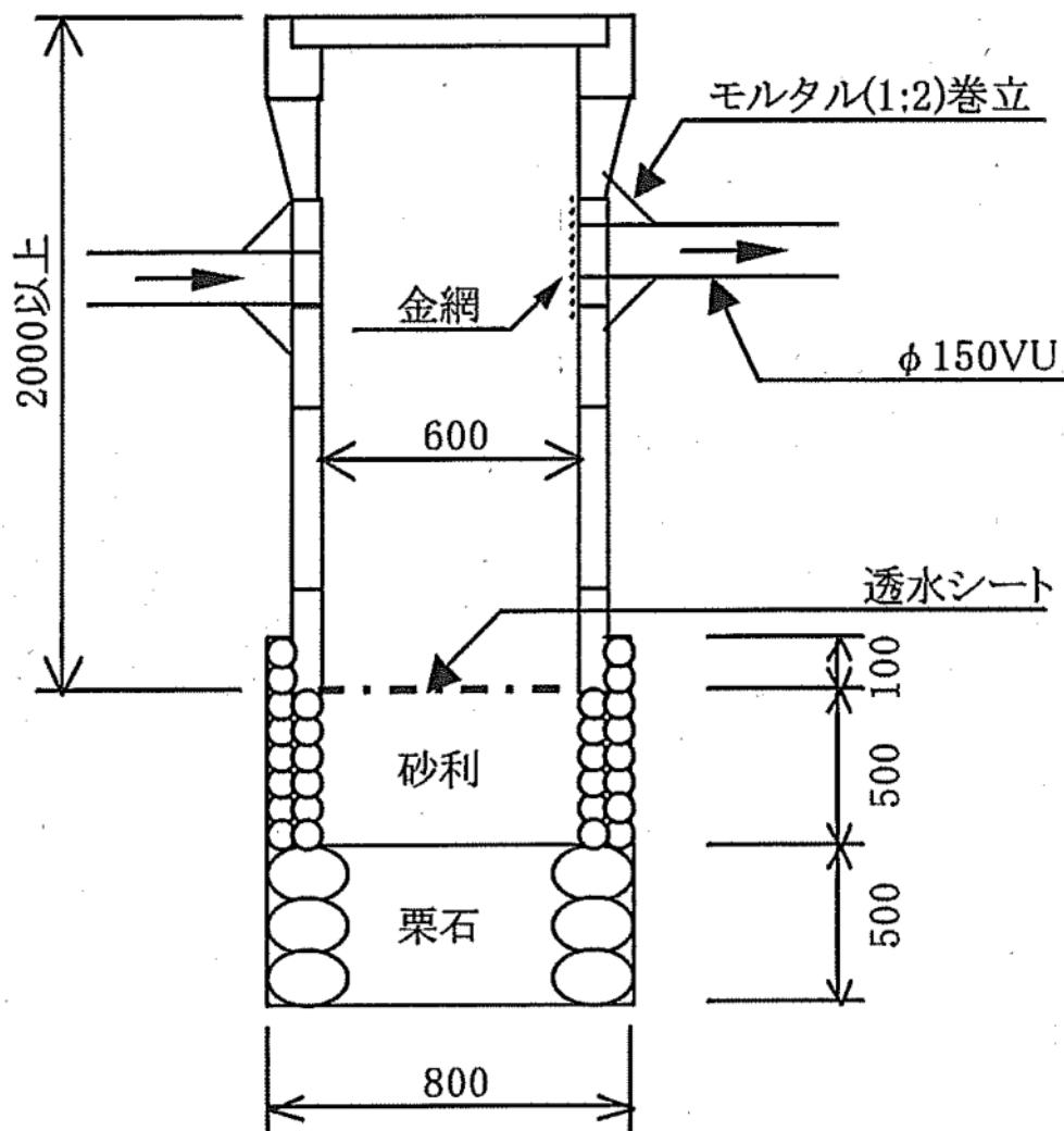
※ポラコン浸透柵を設置し透水を柵の側面からも行う場合は、適宜、柵側面部分まで栗石等で覆ってください。
