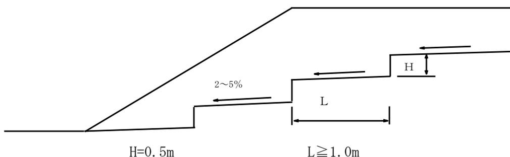
カ のり高の大きい盛土では、のり高 5m 程度ごとに幅 1.0~2.0m の小段を設けてください。
