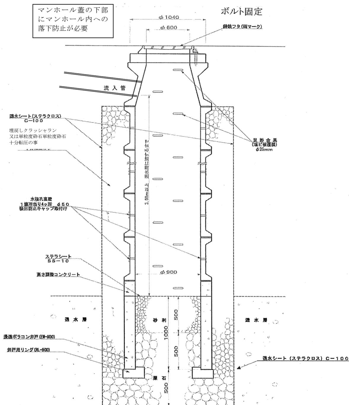
図4-6-2 地下浸透枵標準図（流末がなく1宅地（処理区域）の面積が500㎡未満の場合）
