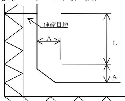
鉄筋コンクリート造擁壁の隅部は該当する高さの擁壁の横筋に準じて配筋すること。
