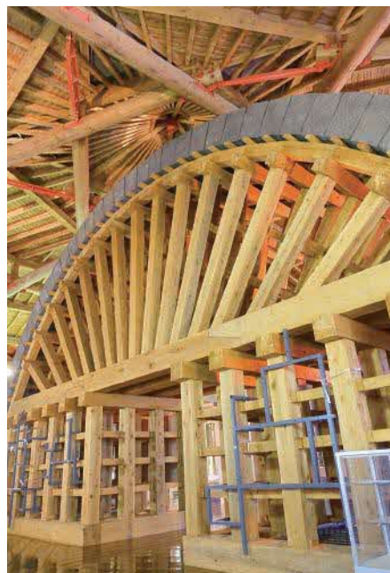
(写真右上) 石匠館内に展示されている支保工模型。上部には石がアーチ状に並び、木組みの土台の上に伐り出した石を積んでいき、最後に土台を抜くと石の自重でアーチが固定される (写真左上) 石匠館内の展示。石工の道具は実際に使用され、子孫によって寄贈されたものが多い (写真左) 石匠館館長上塚 寿朗さん。背後に写る石匠館の外壁に凝灰岩が使用されている
