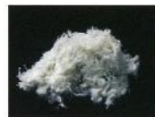
白石綿(クリンタイル)
