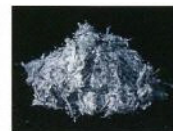
青石綿(クロシドライト)
