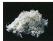
白石綿(クリンタイル)
