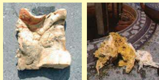
下水道本管から取り出された スポンジと繊維物
