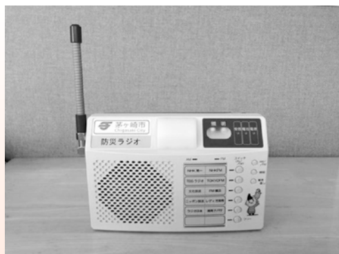
新型防災ラジオ 約600g/横19cm×高さ12cm×幅6.5cm
